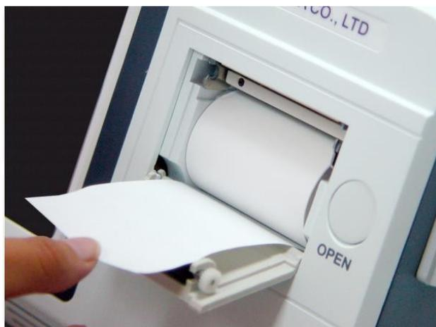
Figura 3.6 Sustitución del papel de impresión
