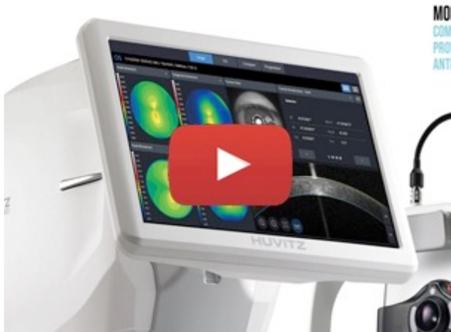
Dado que el HOCT puede analizar la parte posterior de la córnea, los usuarios ahora pueden minimizar los errores causados por el eje anterior y posterior de la córnea, el grosor de la cornea y los errores de refracción causados por las estructuras vítreas y corneales.
